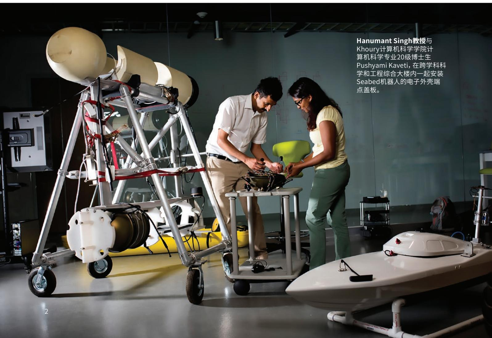
Hanumant Singh教授与 Khoury计算科学学院计算机专业20级博士生 Pushyami Kaveti, 在跨学科科学和工程综合大楼内一起安装 Seabed机器人的电子外壳端点盖板。
